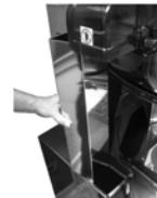
Retire la cubierta frontal, moviéndose lentamente hacia arriba y hacia.
